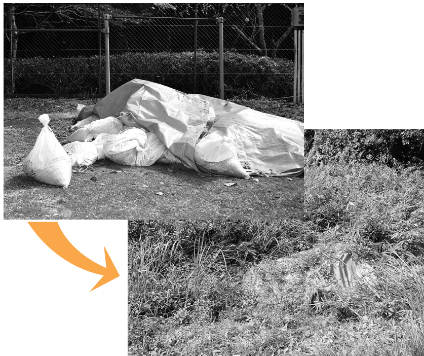
草まみれになった土のう
