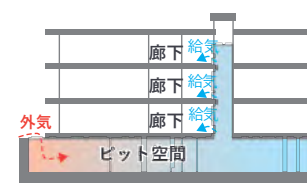
[クール・ヒートトレンチ]
