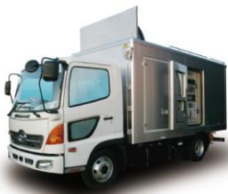
移動式電源車の例
